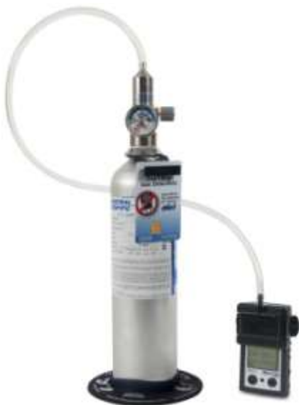
Проверка в режиме диффузионного отбора проб с постоянным расходом
